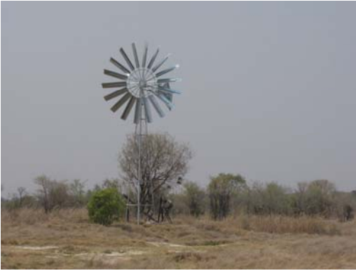
Figure 12 – Pompe éolienne expérimentale installée par FOH à la mare de Makwa.
